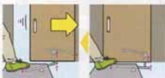
◆ドア内部に斜めに取り付けであるバーに、滑車による上方への力が伝わると、バーはドアとともに左右方向に移動し、開く仕組み。
